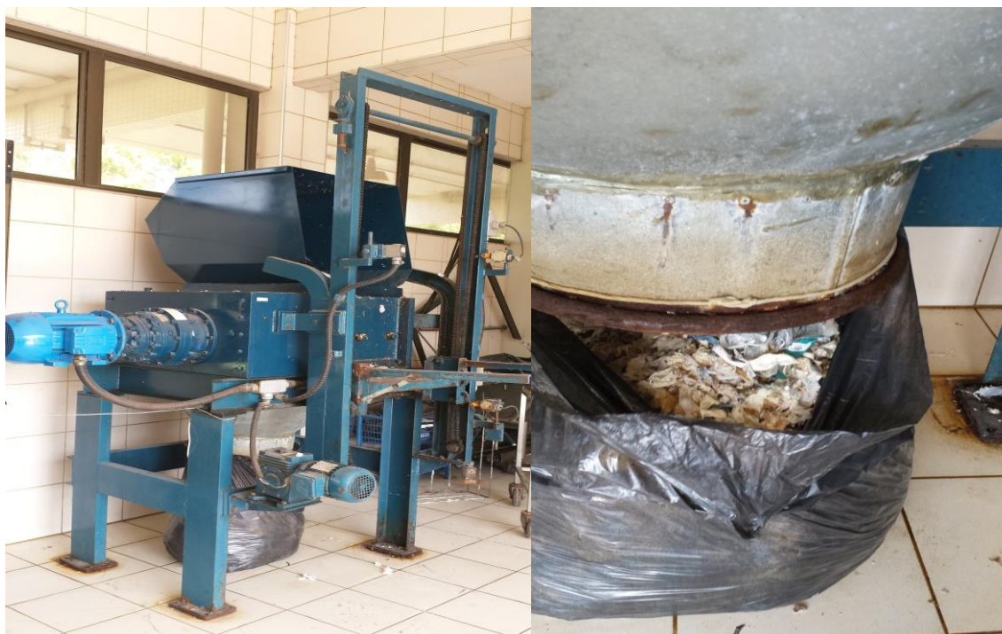
Fotografia 36 - Triturador da Central de Resíduos do HRBA.
