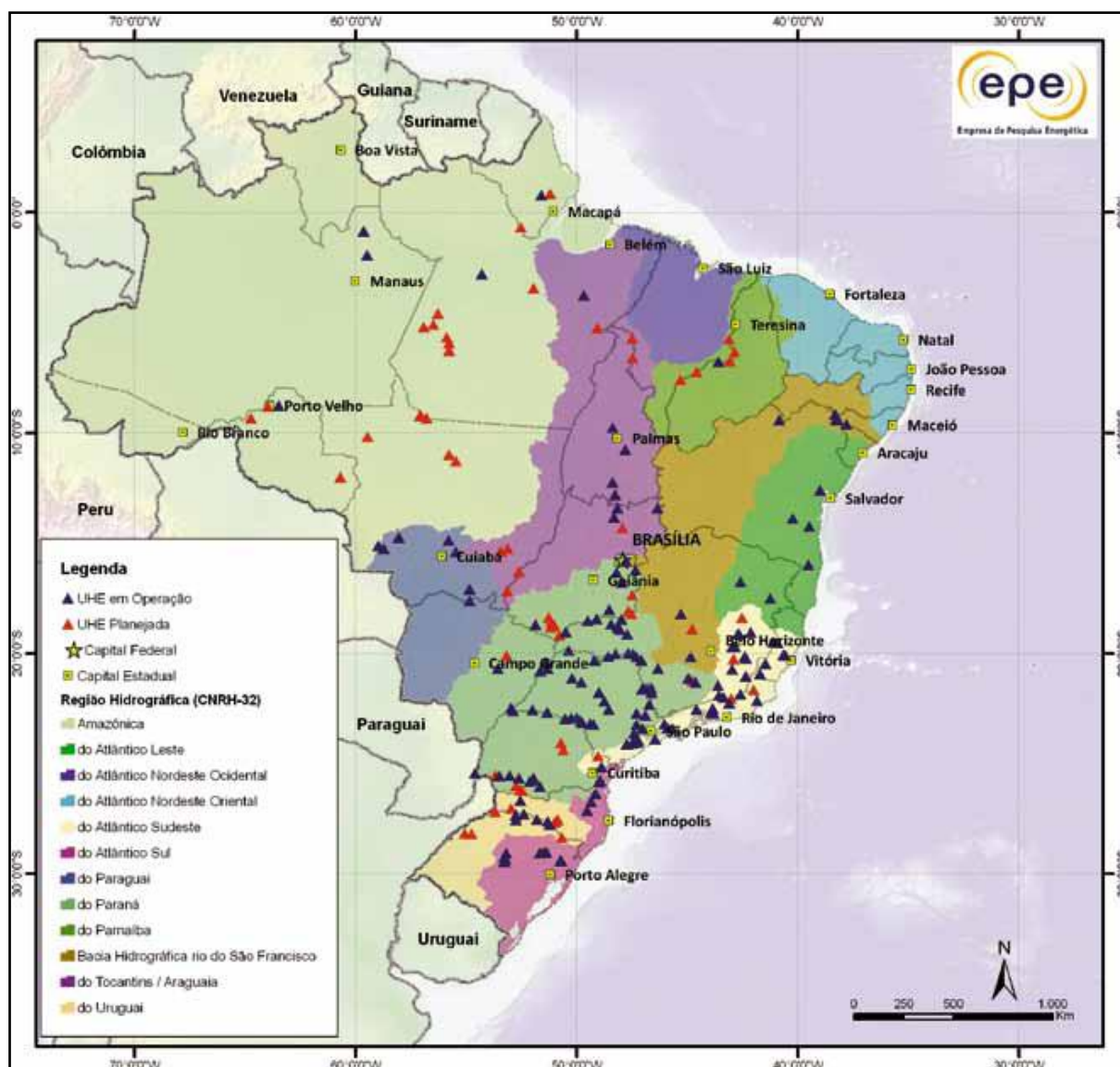
Figura 4 - Sistema de Geração Hidrelétrica (existente e planejado)
