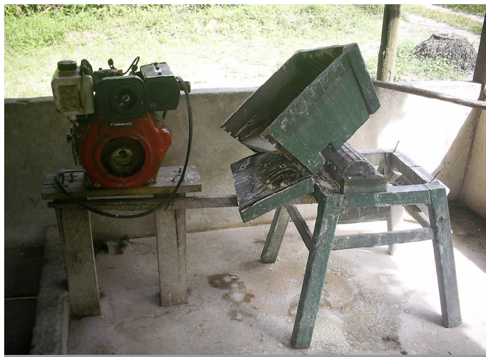
Fotografia 16 - Motor de ralar mandioca da casa de farinha da Matinha Fonte: Freire (2008)
