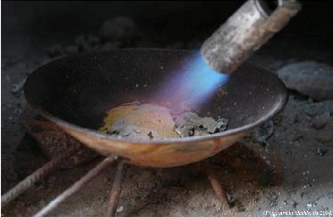
**Figura 06 – Amálgama sendo queimado com maçarico.**
