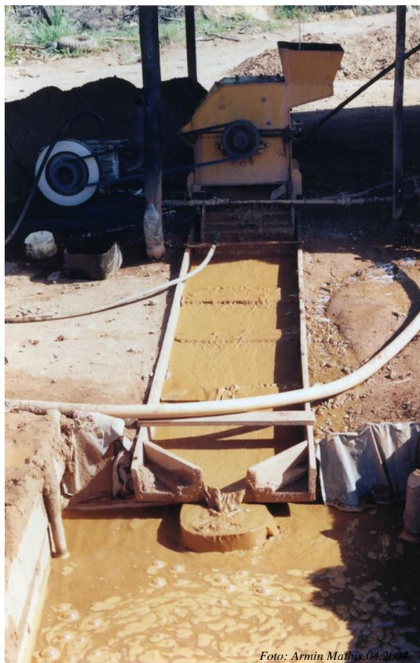
**Figura 05 – Seqüência de placas após o moinho, para amalgamação.**
